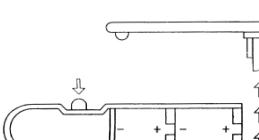
Schroef het batterijdeksel los en plaats 2 x AAA-batterijen. Let op de polariteit, de + pool wijst naar het batterijdeksel.
